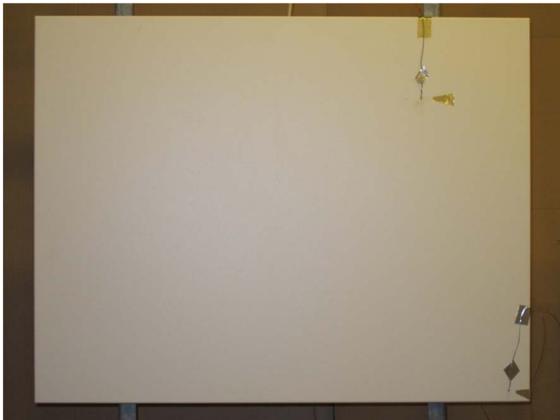
Abbildung 3: Vorderseite des Strahlungsheizkörpers mit zwei Temperaturfühlern
